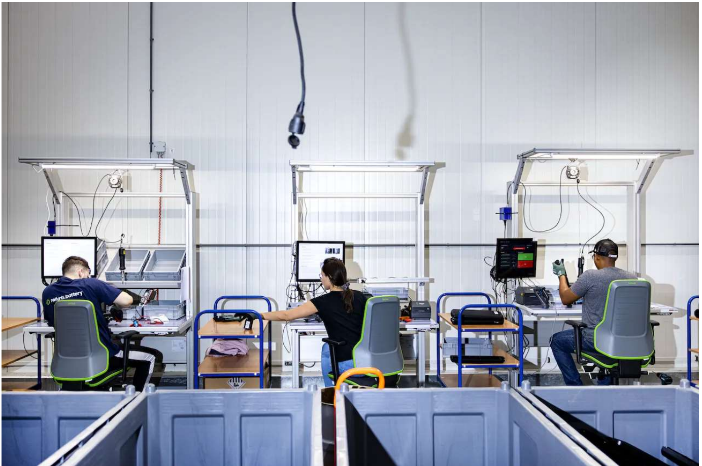
Op hun werkstation halen de medewerkers van Refurb Battery de afgedankte fietsaccu's uit elkaar en sorteren de lithium-ioncellen en andere materialen. Foto: Ramon van Flymen voor het FD
